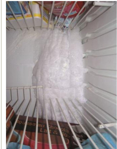
Un réfrigérateur ou un congélateur mal dégivré génère une surconsommation d'électricité.
