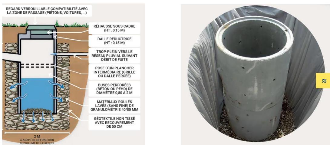
Figure 5 : Schéma d'un puits d'infiltration et photographie d'un puits en construction [32]
